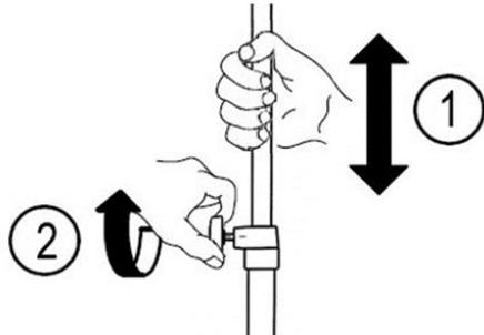
Halten Sie zur Höhenverstellung das obere Rohr ① fest und lösen Sie danach die Klemmschraube ②. Stellen Sie die gewünschte Höhe ein und schrauben Sie die Klemmschraube wieder fest. Lassen Sie das obere Rohr erst los, wenn die Klemmung für die gewünschte Nutzung ausreichend ist. Bitte bedenken Sie hierbei das noch hinzukommende Gewicht der Infusionsbehälter.
