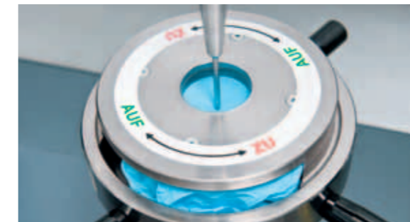
Materialprüfung auf Durchstichfestigkeit
